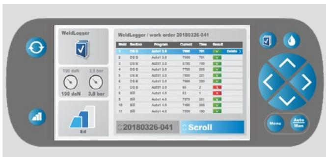
Le **CTR9** enregistre les données de soudure et génère des rapports pendant le processus de réparation. Imprimer le rapport pour attester de la qualité de la soudure et renforcer la confiance dans votre atelier de carrosserie.
