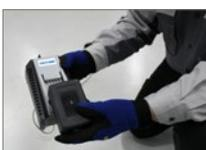
La unidad de carga tiene una función de carga rápida. La batería puede usarse de nuevo solo después de 45 minutos de carga, y está completamente cargada después de 90 minutos.
