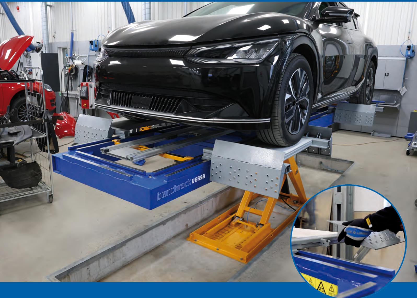
Die neuen kurzen Rampen erleichtern das Anheben an den Rädern und ermöglichen einen schnellen und sicheren Prozess, um das Fahrzeug auf eine optimale Arbeitshöhe zu heben. Die Rampen sind aus hochfestem Stahl und Aluminium gefertigt, was für ein geringeres Gewicht und eine bessere Ergonomie sorgt.
